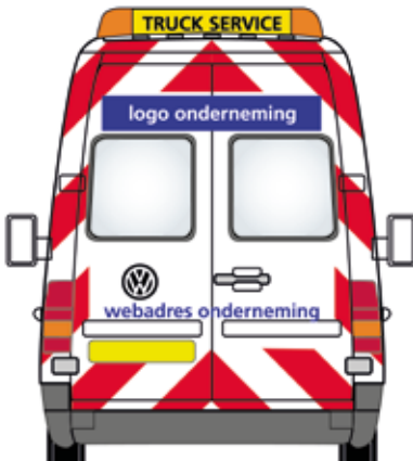
AFBEELDING 4. UNIVERSELE STRIPING. DE RODE STREPEN HEBBEN EEN BREEDTE VAN 30 CM EN MAKEN EEN HOEK VAN 45 GRADEN MET DE HORIZONTALE AS.
